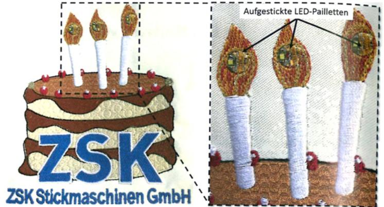
Abbildung 4: Stickmuster mit integrierten LED-Pailletten [Bildquelle: ZSK Stickmaschinen GmbH, Krefeld, Germany]
