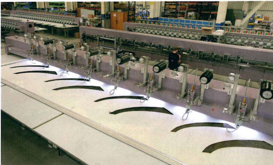
Abbildung 5: TFP-Stickmaschine des Typs ZCW der Firma ZSK Stickmaschinen GmbH mit acht Stickköpfen und einem Stickfeld von vier Quadratmetern [Bildquelle: ZSK Stickmaschinen GmbH, Krefeld]
