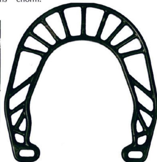
Der topologieoptimierte Brake-Booster wurde aus einem 12k-Kohlefaserroving und Epoxidharz hergestellt, dessen Gewicht damit nur noch 19,8 Gramm betrug. Dies führt zu einer massenspezifischen Steifigkeit von 11,5 N/mm/g, die deutlich größer ist als die des Referenz-Bauteils aus Aluminium.
