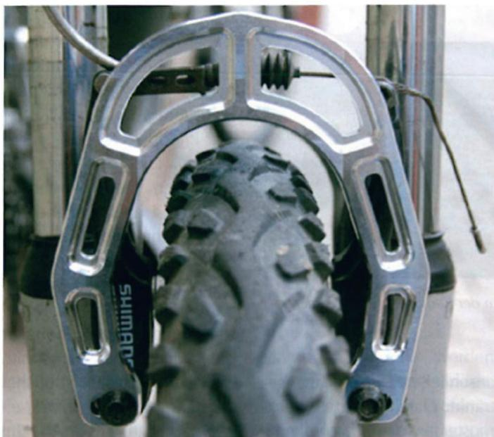
Abbildung 8: Verbaute Brake-Booster aus Aluminium an einer Cantilever-Bremse [Bildquelle: Spickenbauer]
